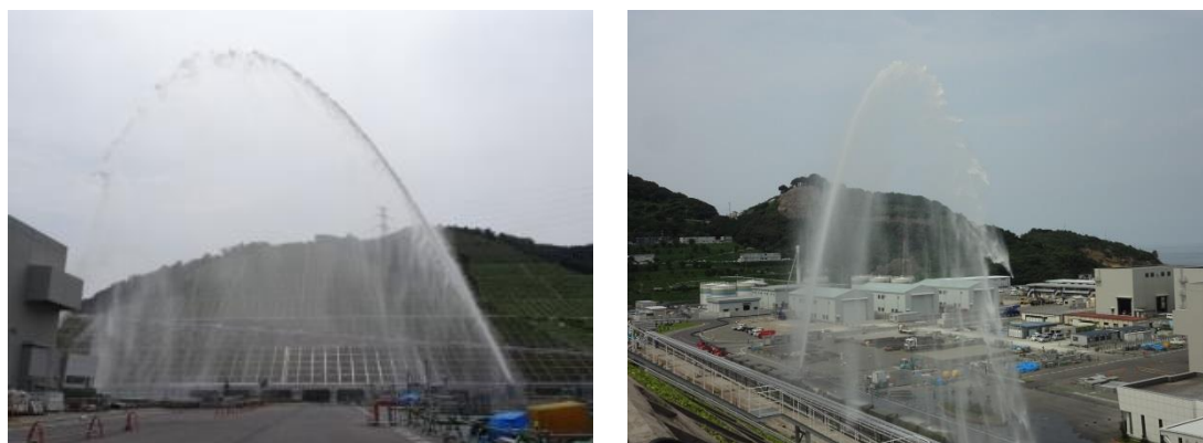
第4図 直状放射による放水
