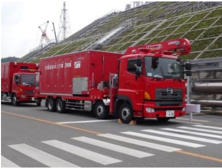
大型送水ポンプ車
