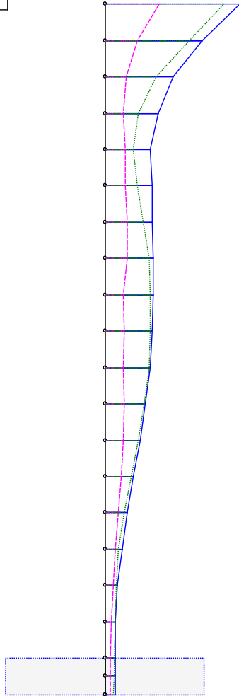
図 4-11 最大応答加速度 (Ss, EW 方向)
