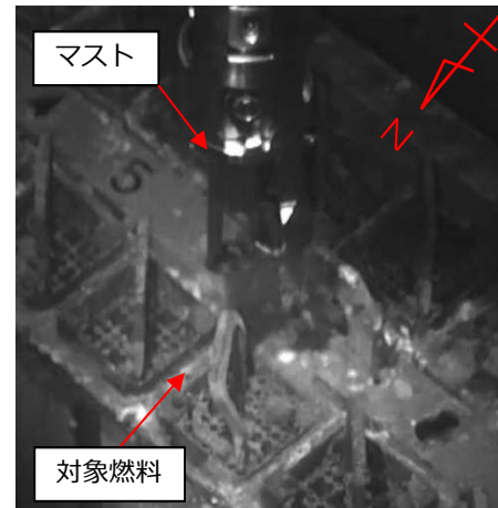
マストと配管の干渉により 吊ることができない燃料 (No.⑭※)
