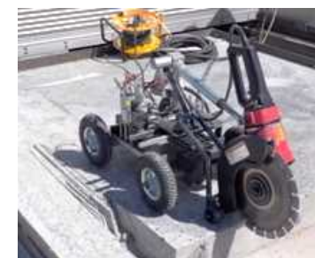
溝切ロボット(モックアップ機)
