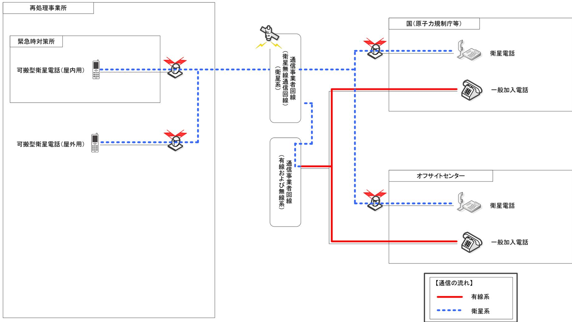
第 2-3-5 図 重大事故等通信連絡設備 (再処理事業所外) [社外関係箇所] の概要 (その 1)
