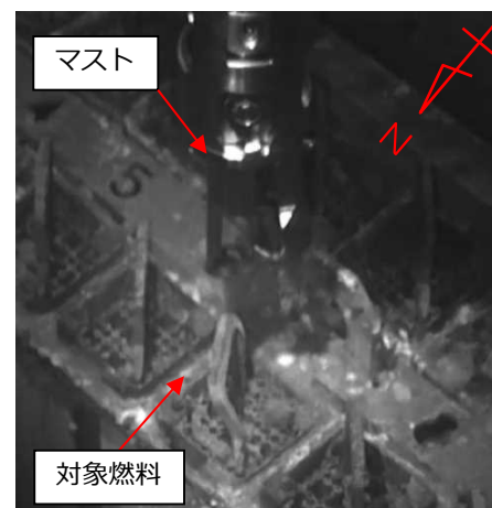
マストと配管の干渉により 吊ることができない燃料 (No.14)
