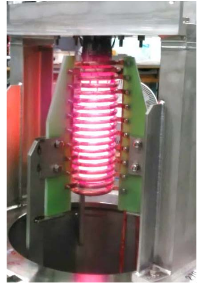
図-7 流下ノズルの加熱状況
