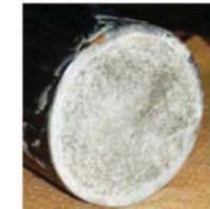
60分保持後、モルタル部からの水漏れ及びにじみなし
