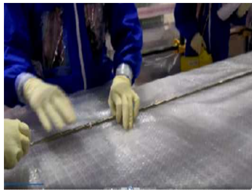
局所変形部検査 (リングゲージ)
