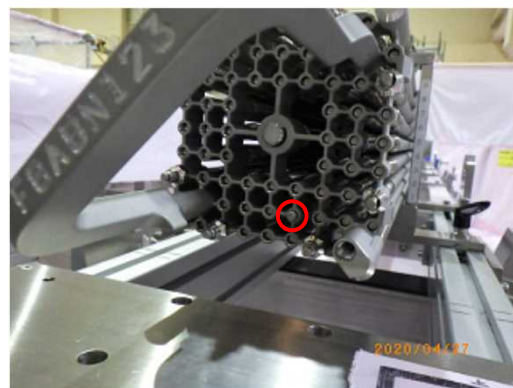
上部タイプレート取り付け
