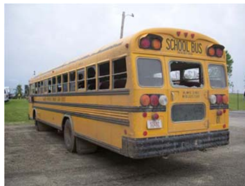
バスの窓ガラス破損
