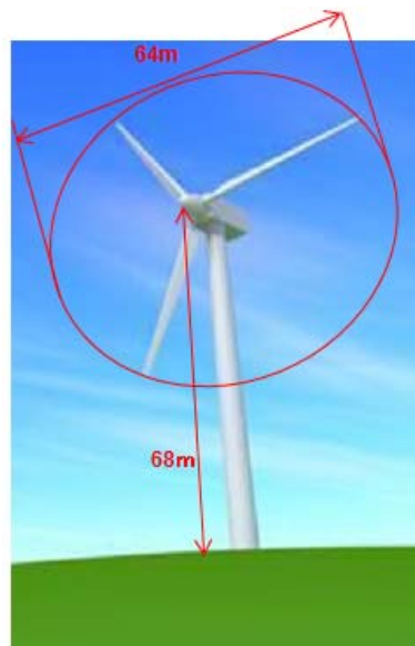
第5-3-1図 風力発電設備の寸法
