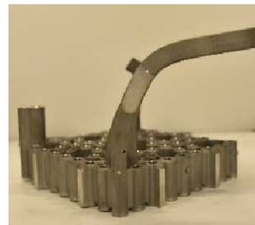
初期変形付与後の上部タイプレート外観
