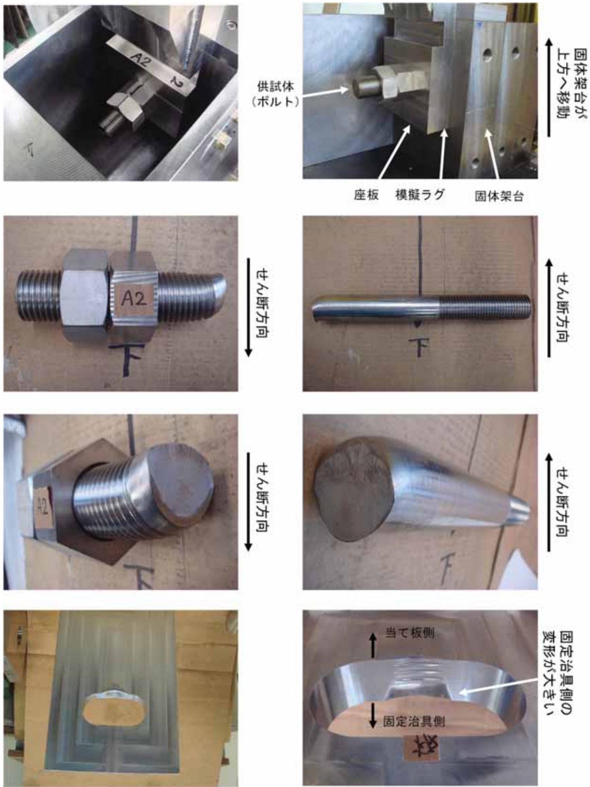
図 13 模擬ラグ A (スリット直交) 2 回目試験の試験後の供試体等の状況
