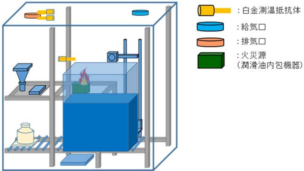
図 4 潤滑油を内包する機器を有する安全上重要な施設のグローブボックスにおける火災感知器の設置例
