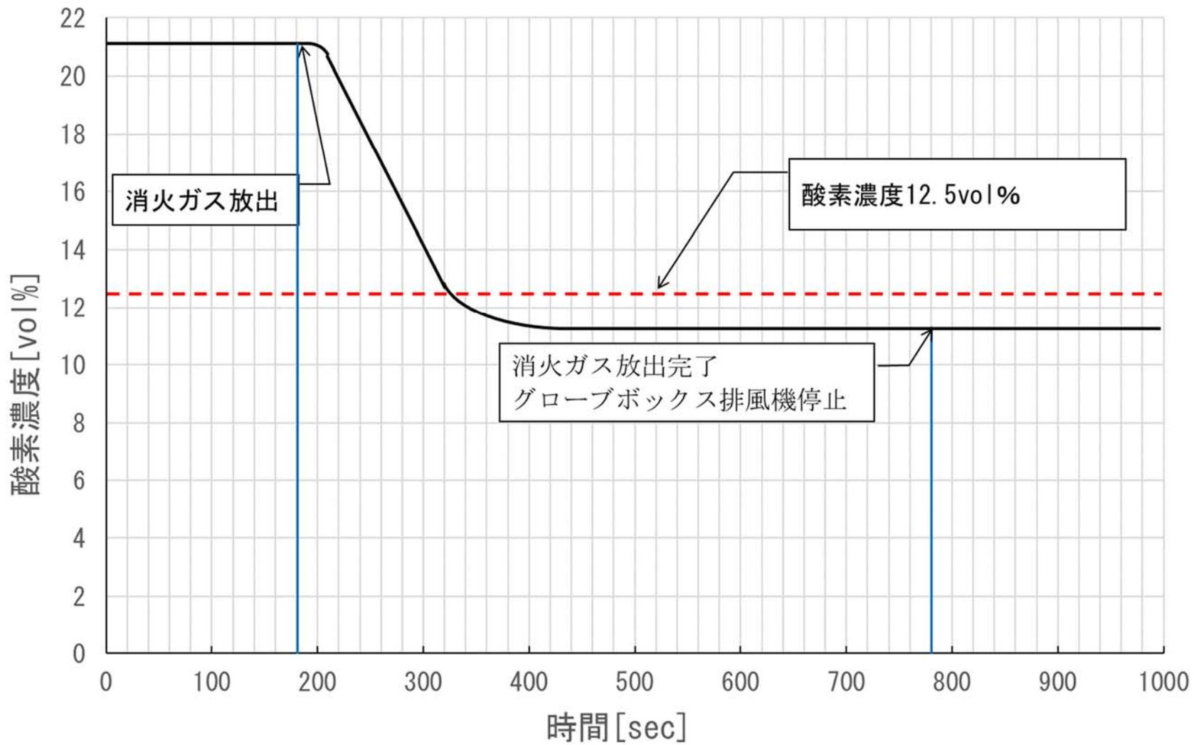
図2 消火ガス放出時のグローブボックス内酸素濃度の変化
