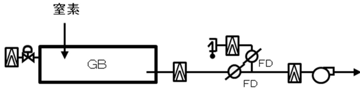
図1 グローブボックス及びその排気系の模擬体
