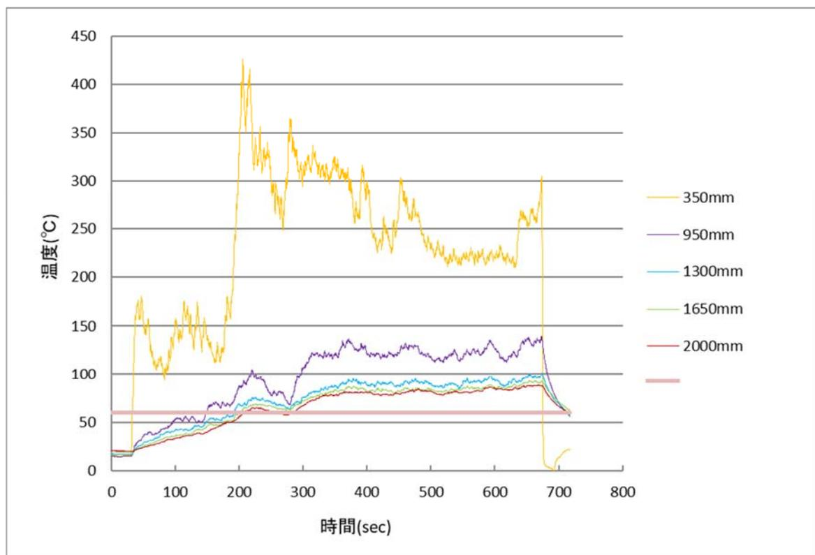
図1 潤滑油火災を模擬した場合における温度上昇と火災感知の性能の比較
