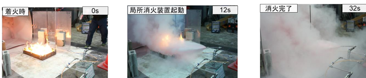
図 9．火災源を ABC 粉末で覆えた場合の試験経過
