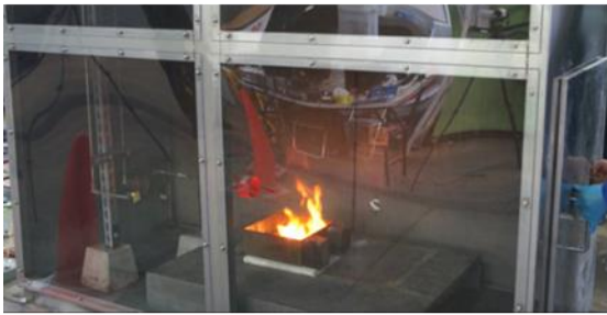
図 2-1. 消火試験におけるカメラの視認性能確認
