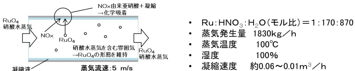
第2図 貯槽から廃ガス処理設備に設置している洗浄塔入口までのラインにおける揮発性Ruの挙動イメージ
