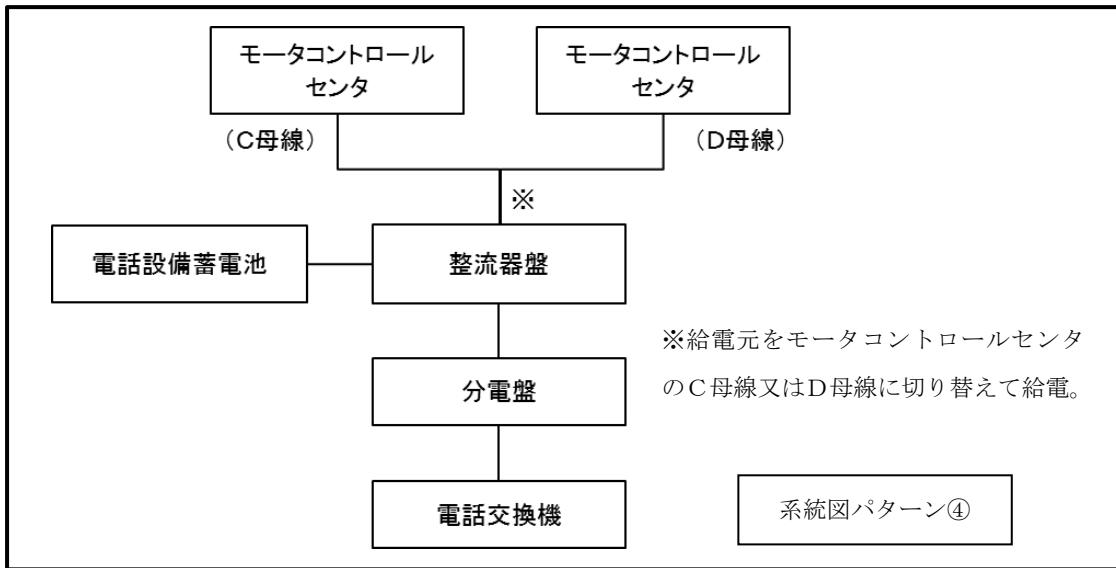
第13-2図 電話交換機における蓄電池への給電パターン系統図
