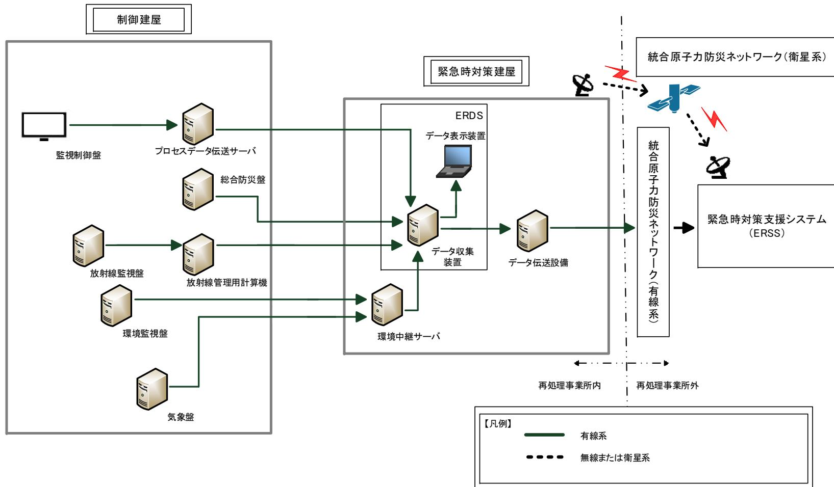
第27. 6図 所内データ伝送設備及び所外データ伝送設備の概要
