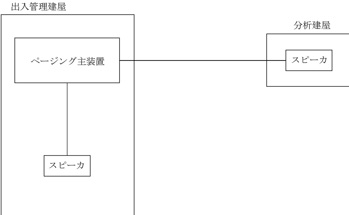
第3-8図 出入管理建屋のページング設備の系統図
