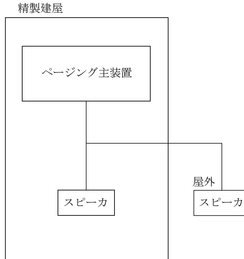
第3－4図 精製建屋のページング設備の系統図
