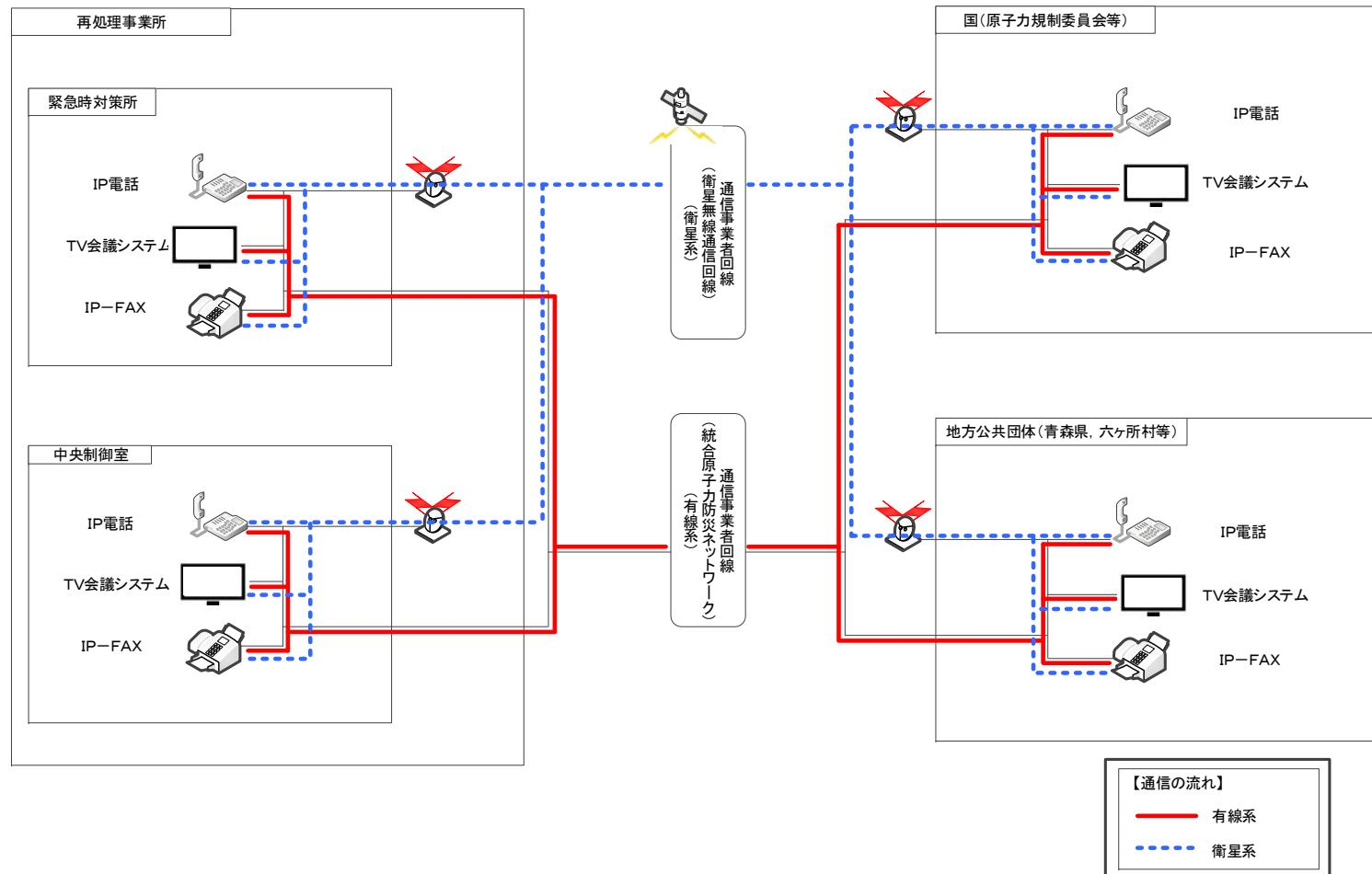
第 27.5 図 所外通信連絡設備（再処理事業所外〔社外関係箇所〕）の概要（その 2）
