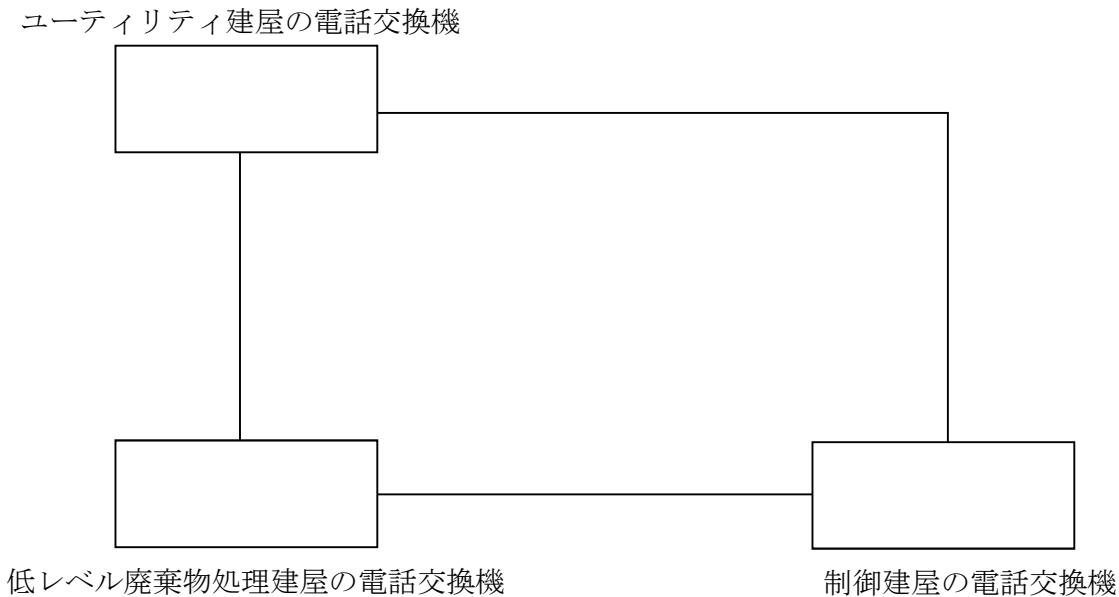
第3-17図 再処理施設の所内携帯電話設備の系統図
