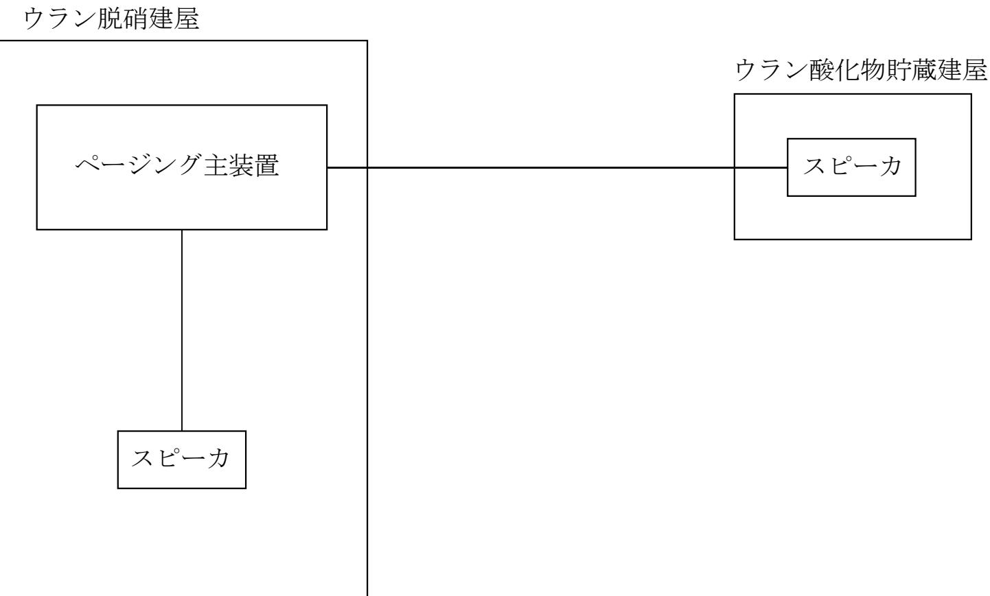
第3-9図 ウラン脱硝建屋のページング設備の系統図
