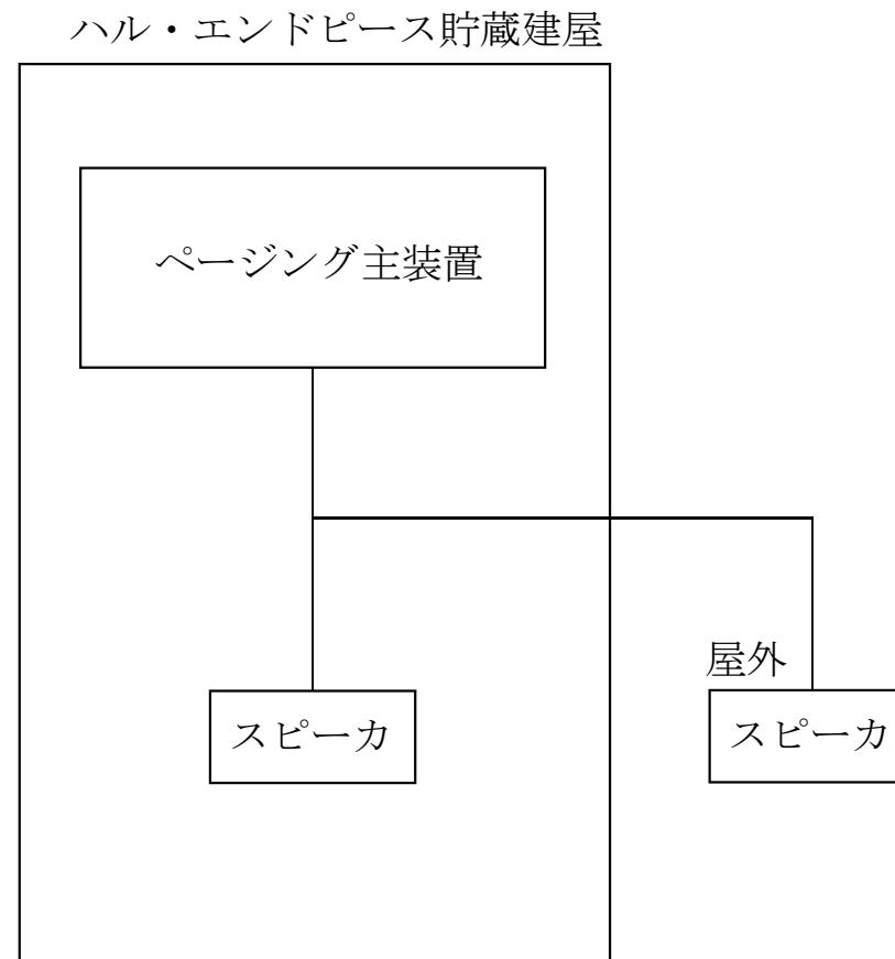
第3-6図 ハル・エンドピース貯蔵建屋のページング設備の系統図
