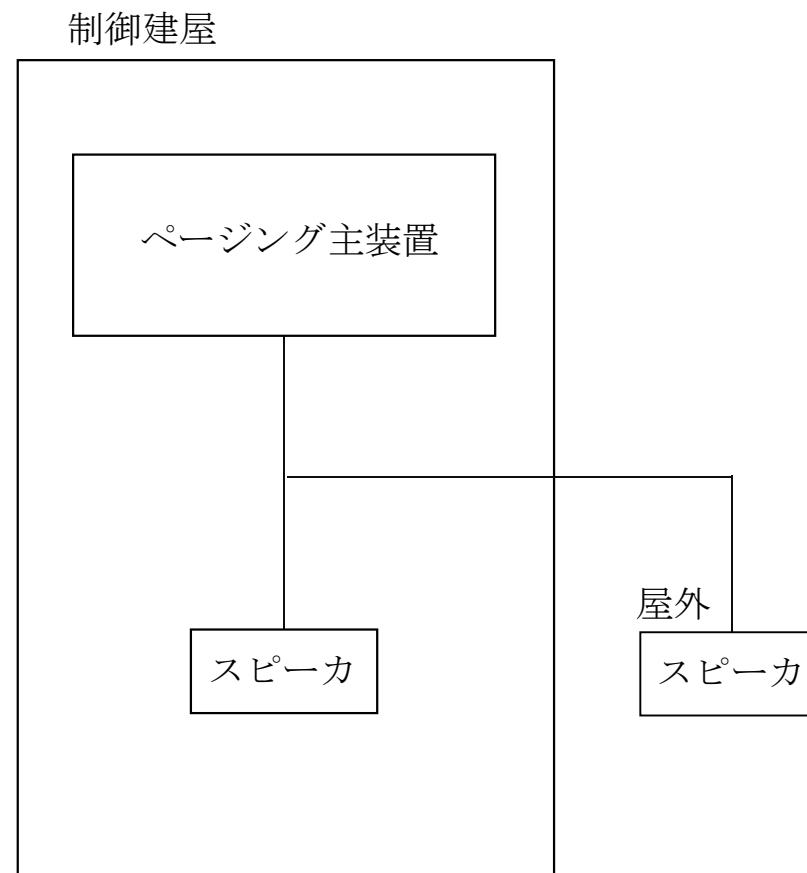
第3－7図 制御建屋のページング設備の系統図
