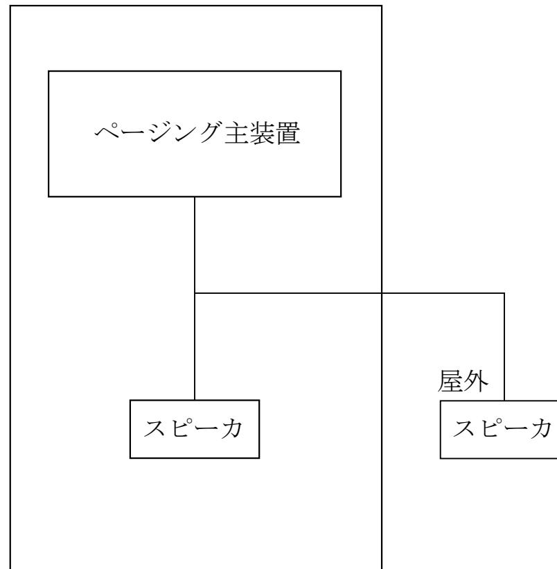
第3-14図 第1ガラス固化体貯蔵建屋のページング設備の系統図
