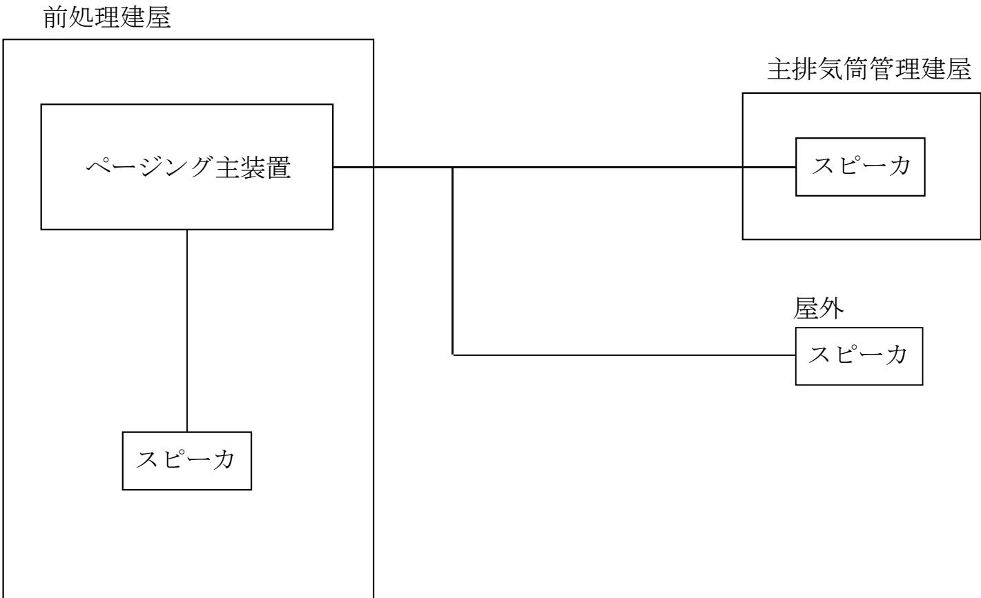
第3-2図 前処理建屋のページング設備の系統図
