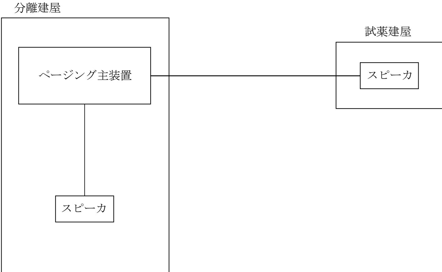
第3-3図 分離建屋のページング設備の系統図
