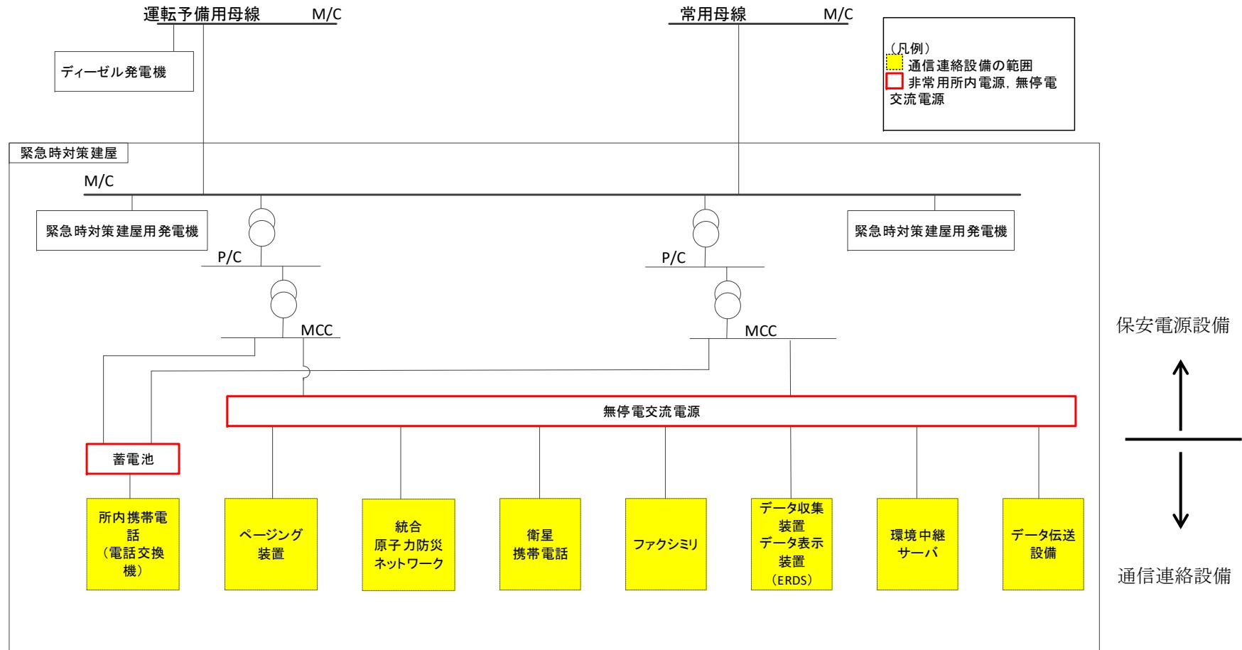
第 27. 9 図 緊急時対策建屋における通信連絡設備の電源構成
