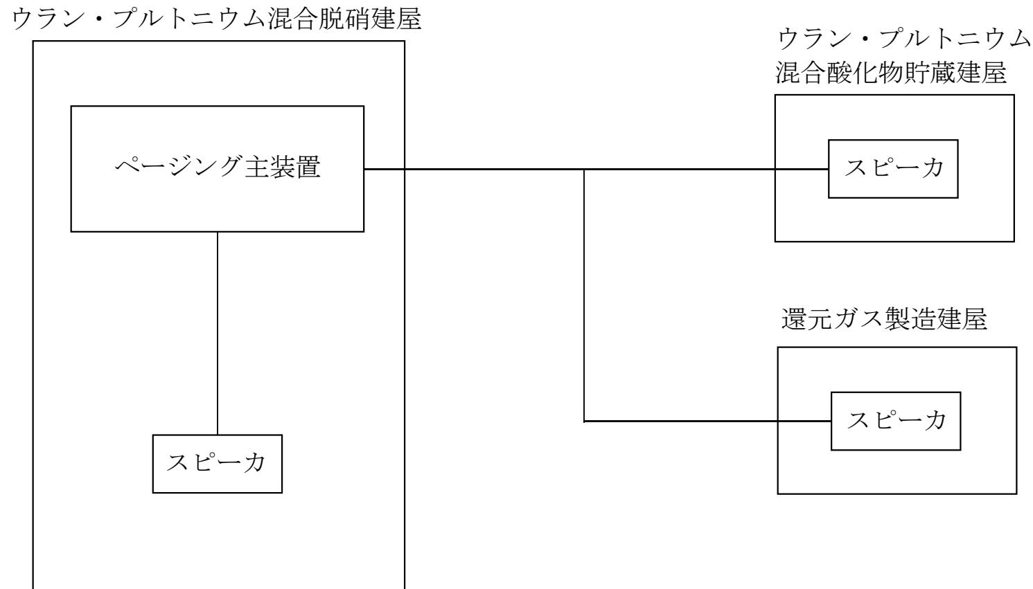
第3-10図 ウラン・プルトニウム混合脱硝建屋のページング設備の系統図
