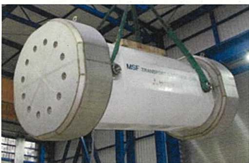
1/1スケールモデル (MSFプロトタイプ) 重量: 127 ton、寸法: φ2.4x 5.3m
