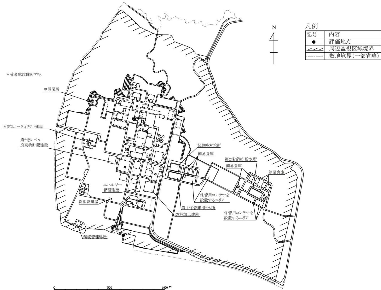
添6第1図 加工施設からの直接線及びスカイシャイン線による公衆の線量評価地点
