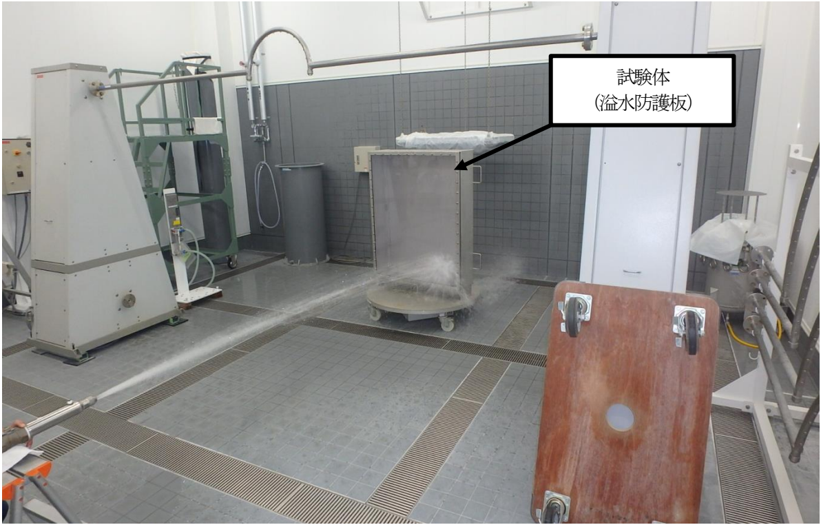
第2図 被水試験の例 (溢水防護板)
