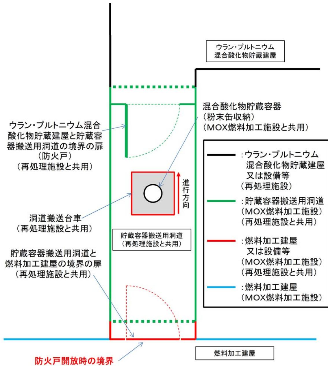
再処理施設境界の扉(防火戸)開放時の概要図(平面図)
