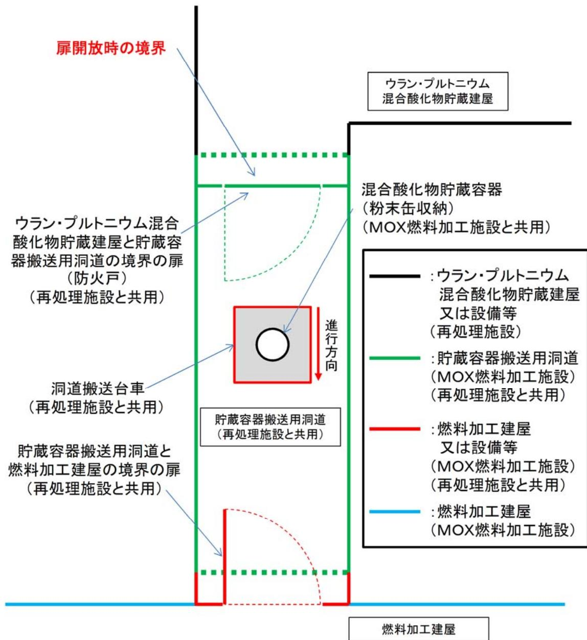
MOX燃料加工建屋境界の扉開放時の概要図（平面図）
