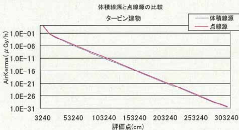
図6-7 体積線源及び点線源モデルの計算結果比較
