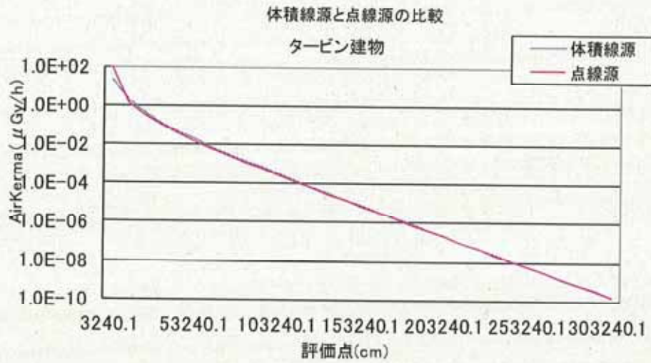
図7-5-2 タービン建物の体積線源及び点線源モデルの計算結果比較
