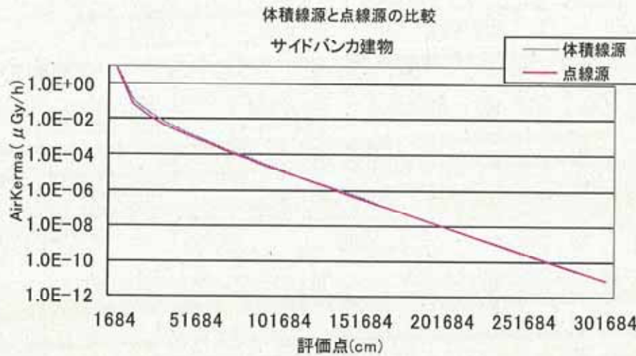
図7-5-6 サイトバンカ建物の体積線源及び点線源モデルの計算結果比較
