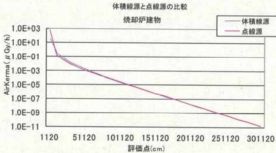
図7-5-5 焼却炉建物の体積線源及び点線源モデルの計算結果比較
