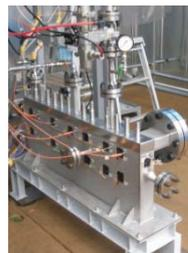
第3図 補助油水分離槽を模擬した容器
