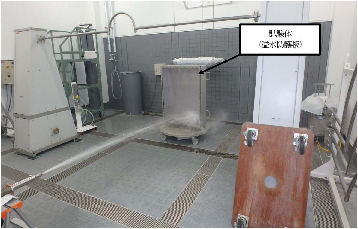
第2図 被水試験の例 (溢水防護板)
