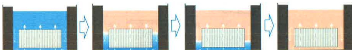
図9 使用済燃料ピット水温が均一になるプロセス（イメージ）
