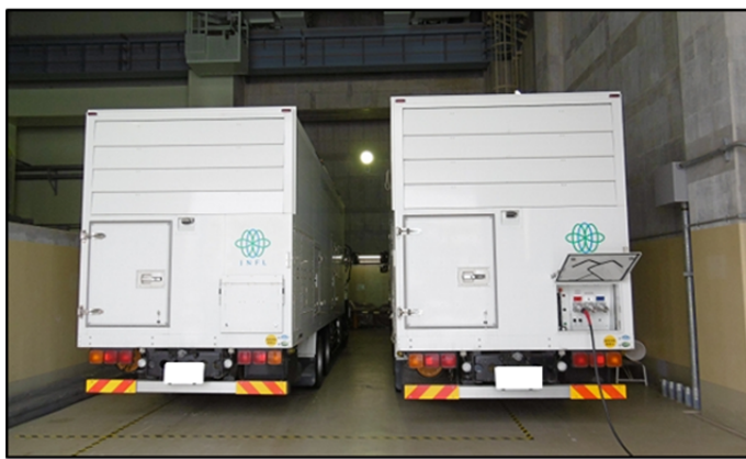
使用済燃料輸送容器管理建屋における電源車配備状況
