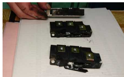
損傷の確認された整流器 (4月5日)
