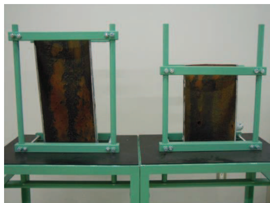
女川 1 号炉 復水浄化系配管の減肉
