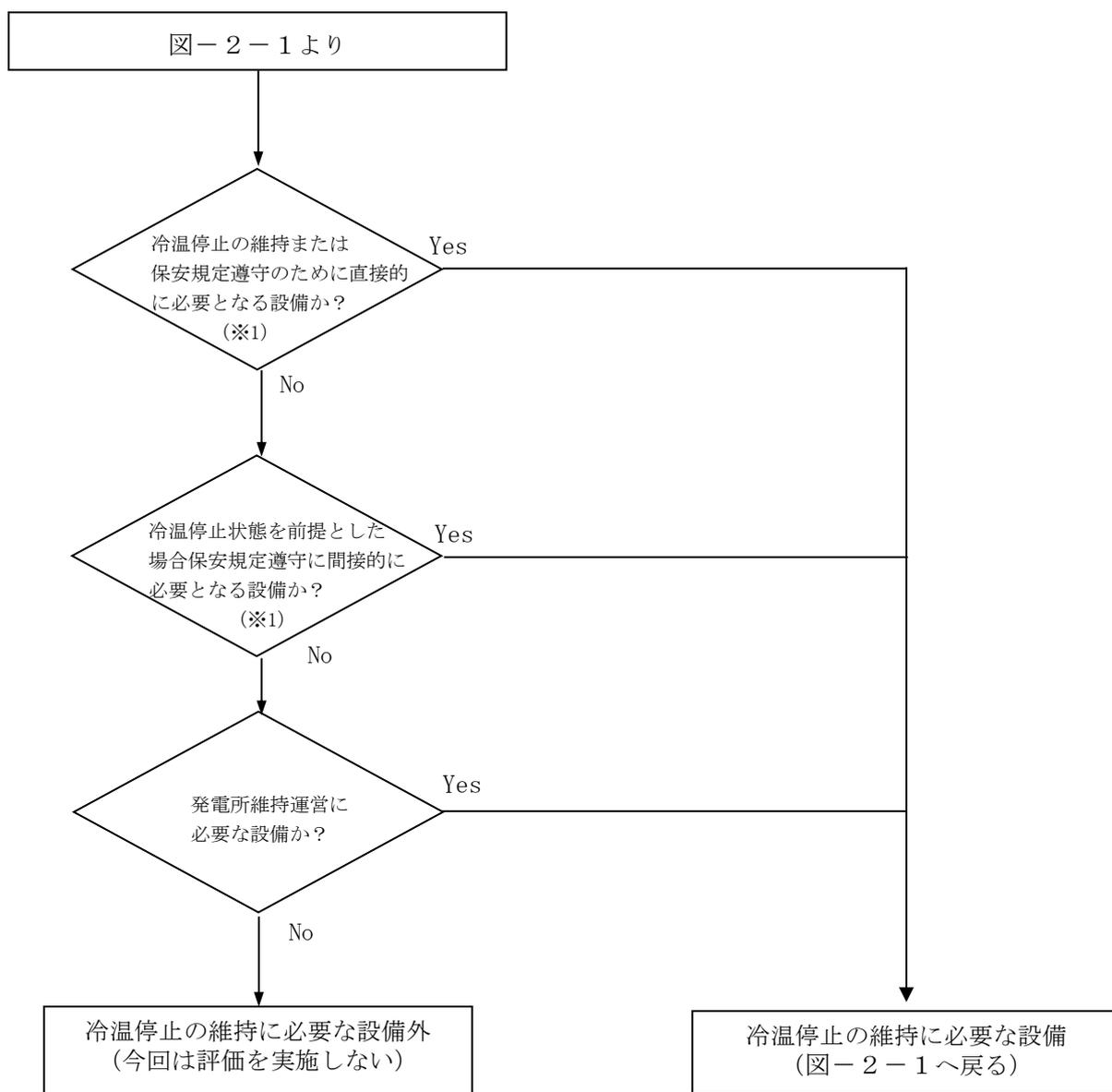
※1：保安規定において「原子炉モードスイッチが燃料取替又は停止及び照射済燃料の移動に対して要求される設備」並びに「運転モードによらず要求される設備」
