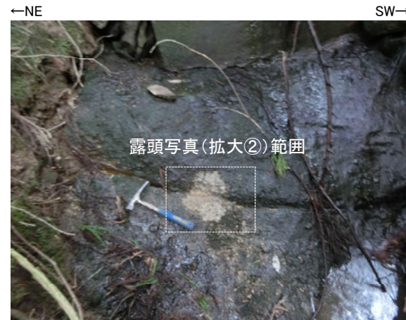
露頭写真(拡大①) 走向N75° Eの節理
