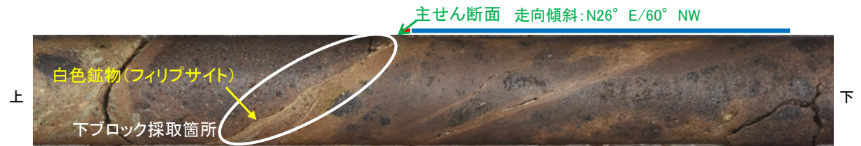
ボーリングコア写真(H' -- 1.3孔) — 粘土状破砕部 — 固結した破砕部
