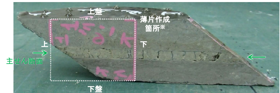
※図示した箇所を観察用薄片を作成し、そこから1mm程度削り込んだ位置でEPMA用薄片を作成した ブロック写真
