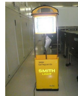
仮設照明(蓄電池式) 42
