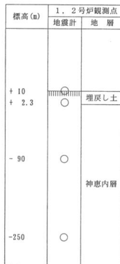
地震計の設置レベル
