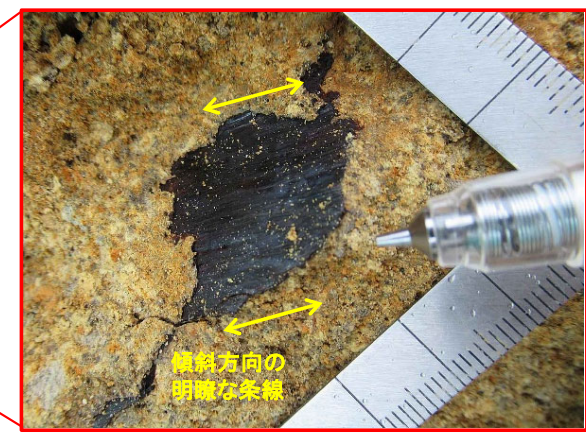
pd系弱面b ・ 走向・傾斜: N79° E, 40° N ・ 傾斜方向の明瞭な条線有り(プランジ角38° N)
