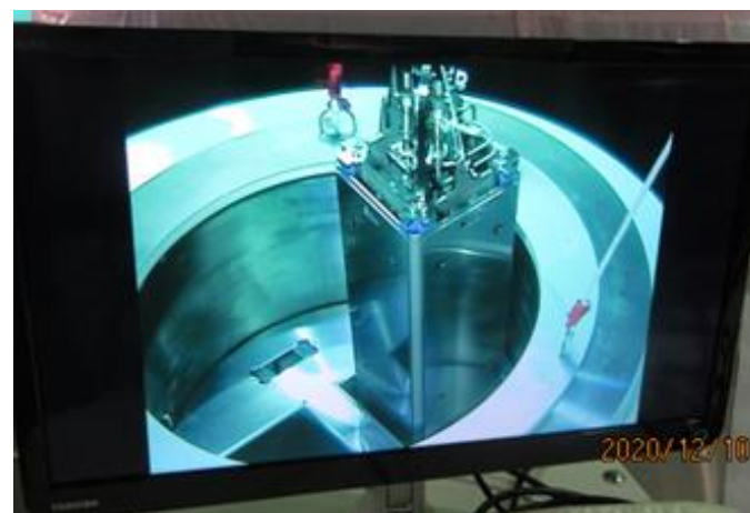
収納缶の吊り上げ状況
