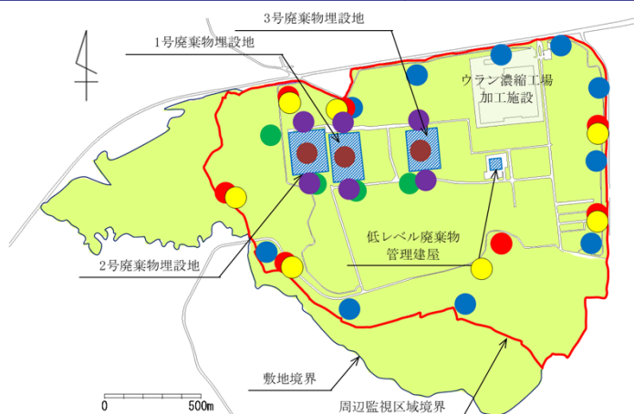
監視測定設備の設置箇所概略図
