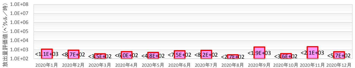
1号機 原子炉建屋、PCVガス管理システムからの放出量推移
