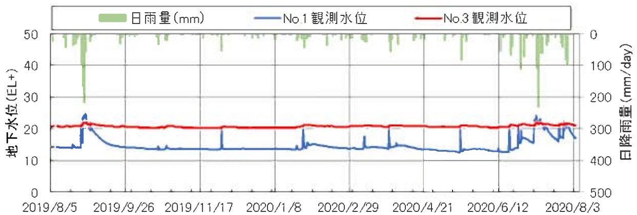
第4図 No.1及びNo.3の観測水位と降雨量の関係
