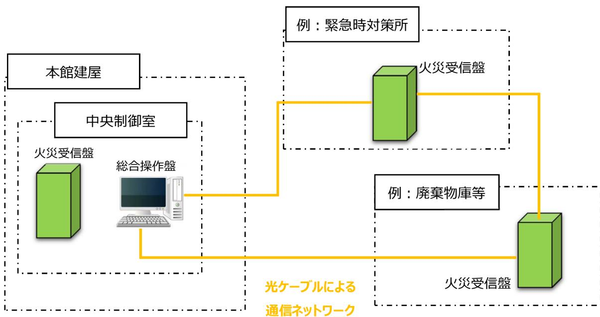
第 4-1-1 図 火災受信機盤の概略系統図
