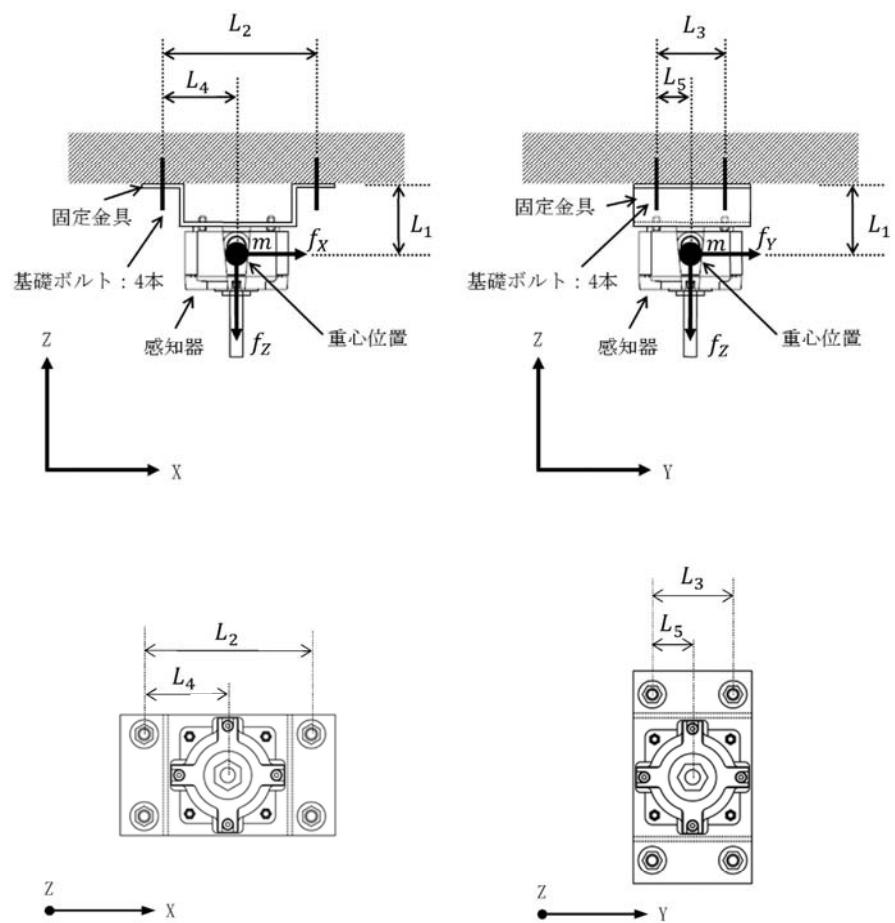
第5-4図 四点固定型（天井支持型）の応力評価モデル
