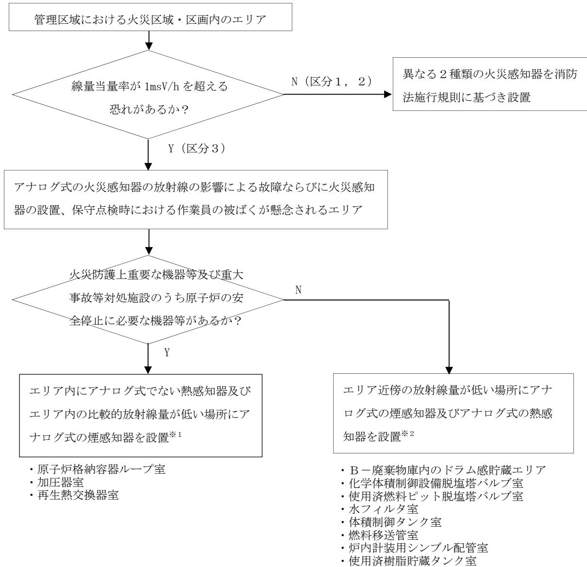
第3-6-2図 放射線量が高いエリアの火災感知器設計フロー
