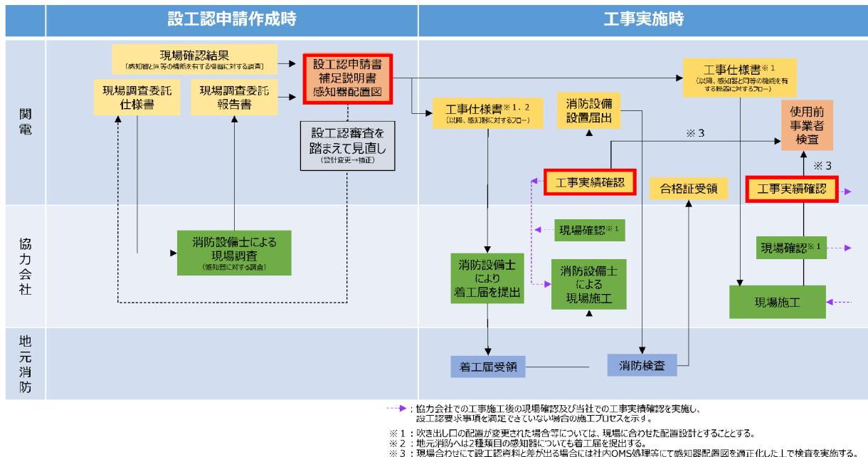
第2-4-1図 設工認申請における設計、工事及び検査実施時のフロー
