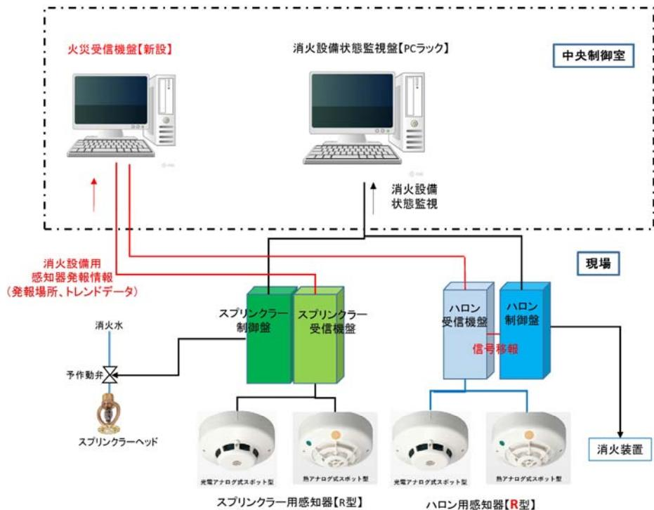
第 4-2-2 図 改造後の消火設備の構成
