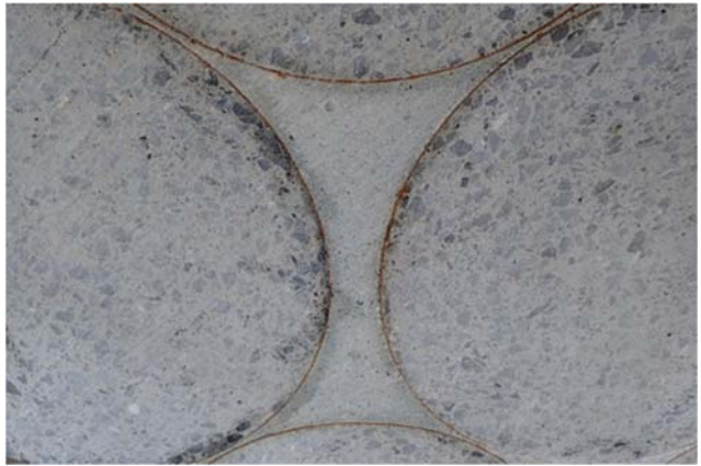
第 31 図 充填状況（輪切り断面）（その 1）
