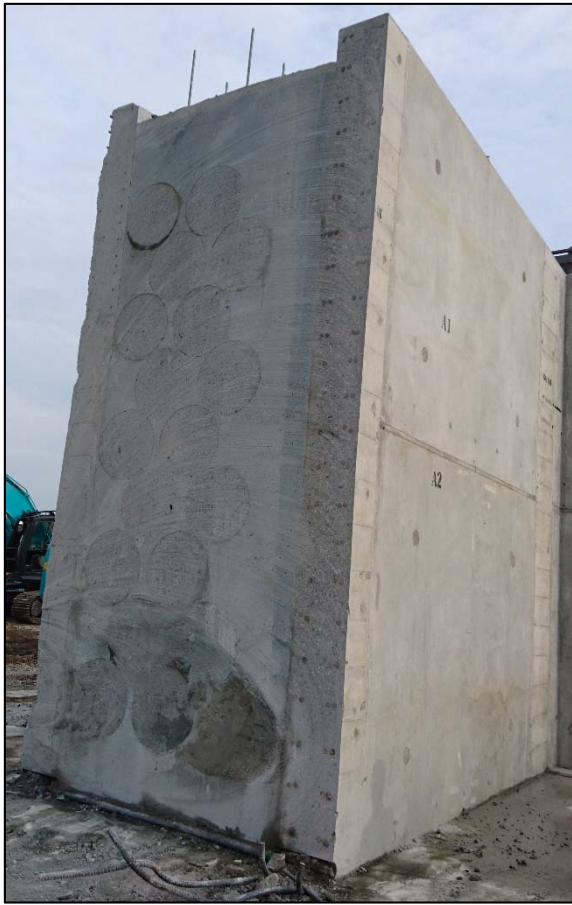
第 31 図 充填状況（輪切り断面）（その 1）
