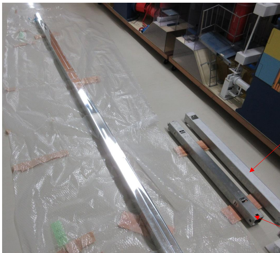
制御棒案内管試作品 (R1 年度製作)
