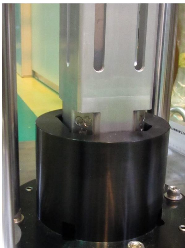
制御棒案内管交換モックアップ試験時写真（H23年制御棒案内管交換時実施）
