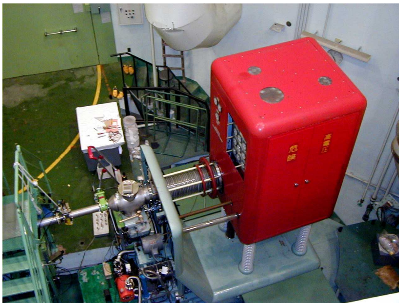
図D-3 パルス状中性子発生装置 (加速器本体)
