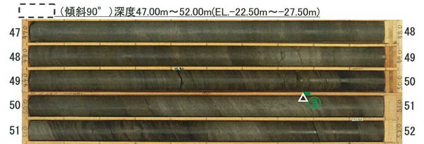
f-102断層延長位置付近のコア写真
