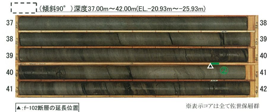
f-102断層延長位置付近のコア写真
