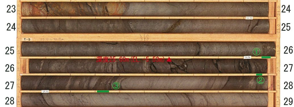
Y-b孔ボーリングコア写真 ▲ : f-143分岐断層の延長位置
