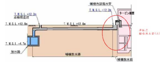
添付第 6-3 図 (5) 7号炉放水路 (E-E 断面)
