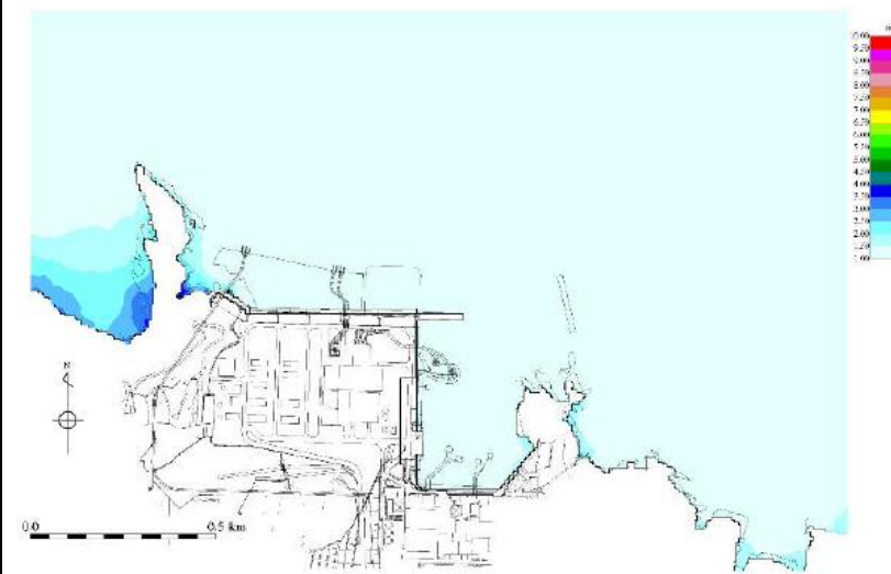
図 4 (2) 入力津波 4 (防波堤有り) 最高水位分布 (F-III~F-V断層から想定される地震による津波)
