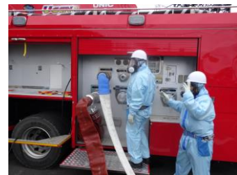
ポンプ起動操作（昼間）
