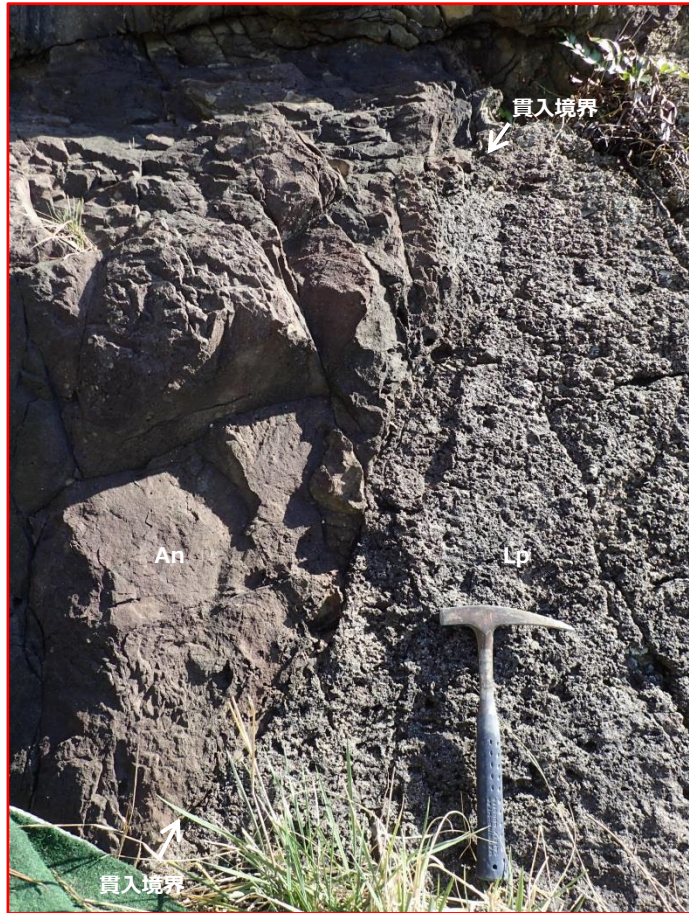
P2 安山岩岩脈 (An)下盤境界 貫入境界は火山礫凝灰岩 (Lp) に密着する。
