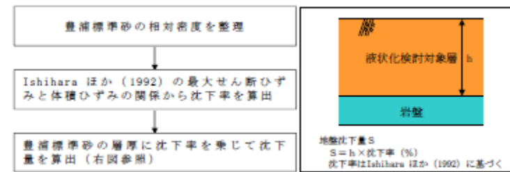
第6図 排水沈下量の算定フロー
