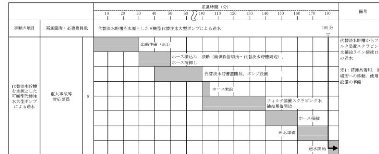
【ホース敷設にホース運搬車を使用する場合、フィルタ装置スクラビング水補給ライン接続口への送水開始まで 180 分以内で可能である。】
