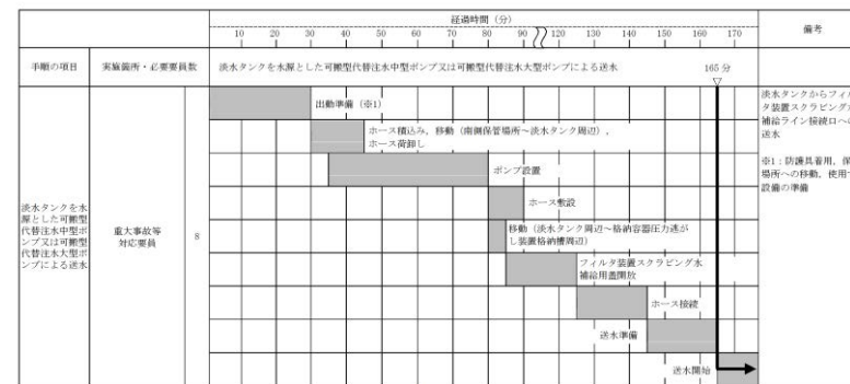
【ホース敷設にホース運搬車を使用する場合、フィルタ装置スクラビング水補給ライン接続口への送水開始まで 165 分以内で可能である。】
