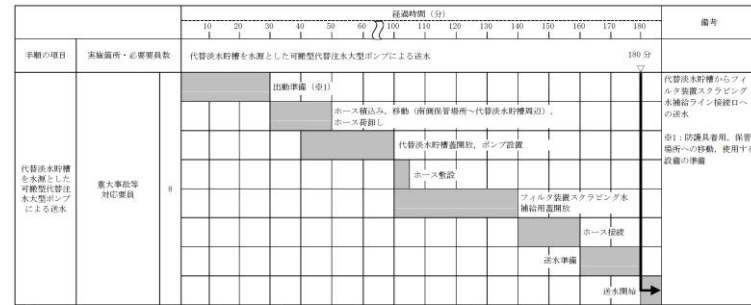
第1.13-7 図 可搬型代替注水中型ポンプ又は可搬型代替注水大型ポンプによる送水(淡水/海水)タイムチャート(5/6)
