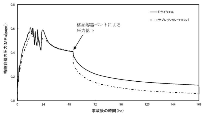
図 52-6-1 原子炉格納容器圧力推移
