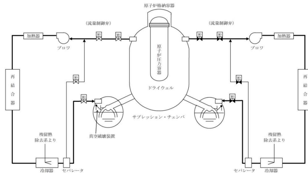
図3 可燃性ガス濃度制御系による水素濃度制御 概略系統図
