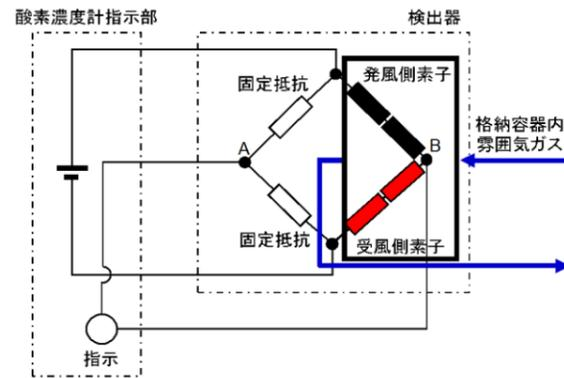
図52-7-3 酸素濃度計検出回路の概要図
