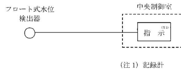
図50-3-14 ドレンタンク水位の概略構成図
