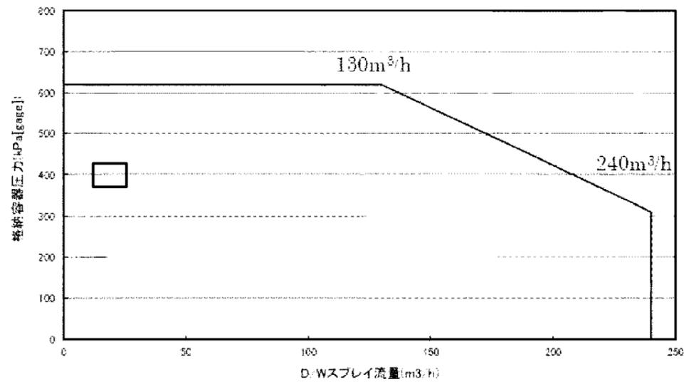
図4 ドライウェルスプレイ注水特性 (ペダスタル50m³/h同時注水時)
