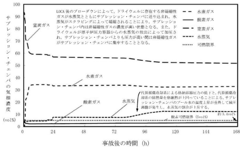
図52-8-2 サプレッション・チェンバの気相濃度の推移(ウェット条件)
