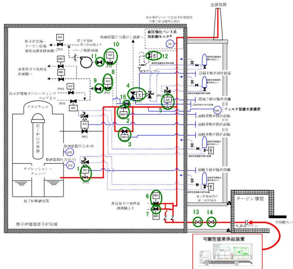
図 52-4-1 耐圧強化ベント系 系統概略図
