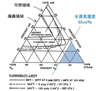
図2 水素、空気及び水蒸気混合条件下における可燃限界と爆轟限界
