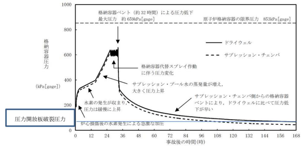
図 6 原子炉格納容器圧力推移 (大 LOCA+SBO+全 ECCS 機能喪失)
