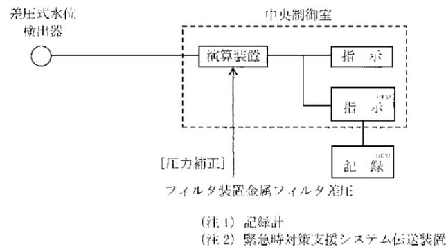
図50-3-2 フィルタ装置水位の概略構成図
