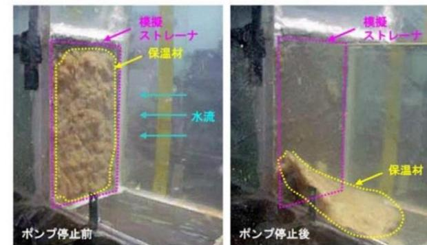
図9 ポンプ停止により模擬ストレーナから試験体が剥がれ落ちた試験
