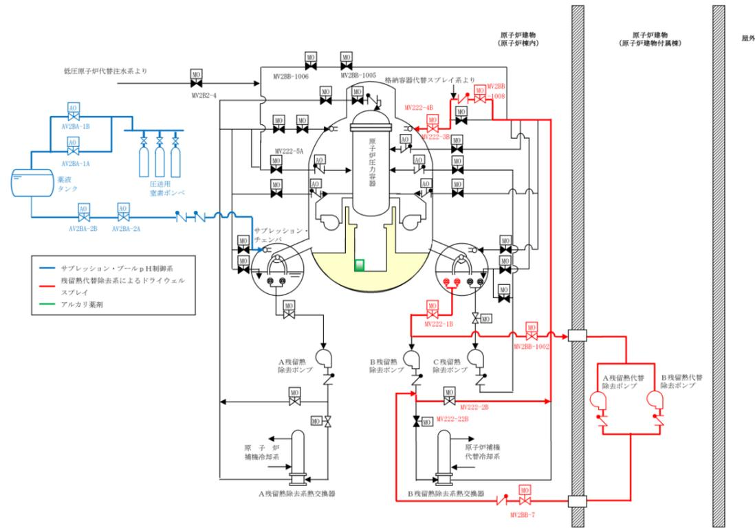
図3 格納容器 pH制御 概略系統図
