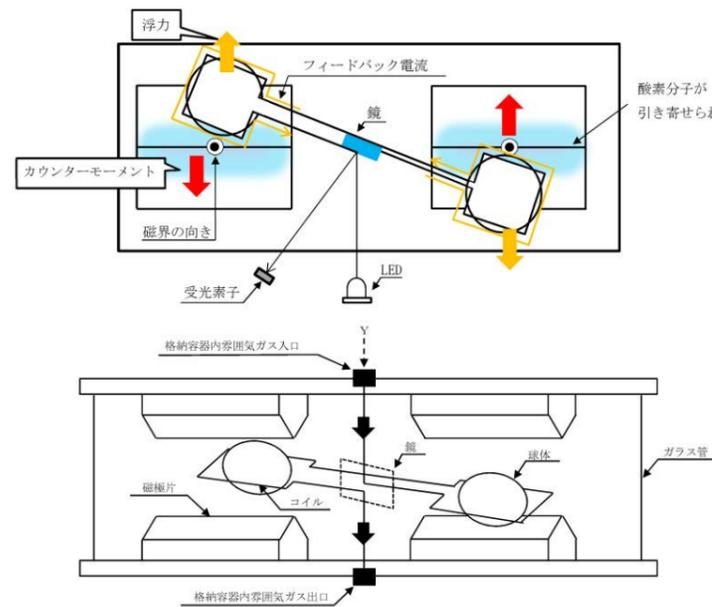
図3 格納容器酸素濃度 (SA) の概要図
