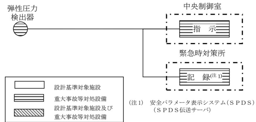
図3 スクラバ容器圧力の概略構成図
