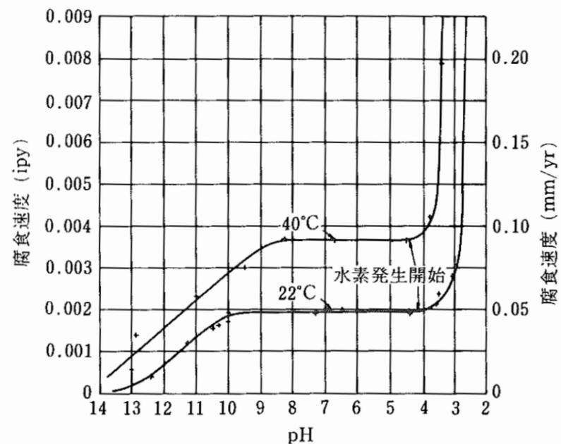
図5 炭素鋼の腐食に及ぼす pH の影響<sup>[1]</sup>
