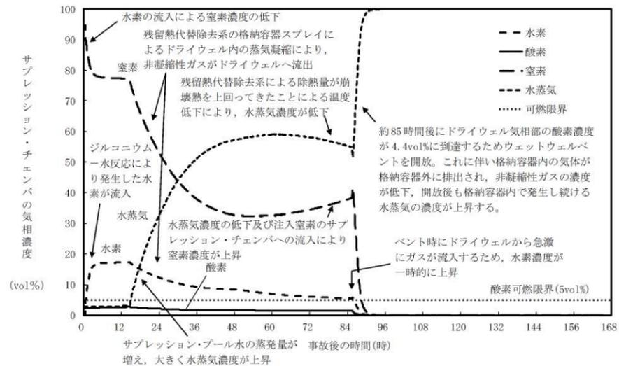
図52-8-4 G 値を設計基準事故ベースとした場合のサブプレッション・チェンバの気相濃度の推移 (ウェット条件)
