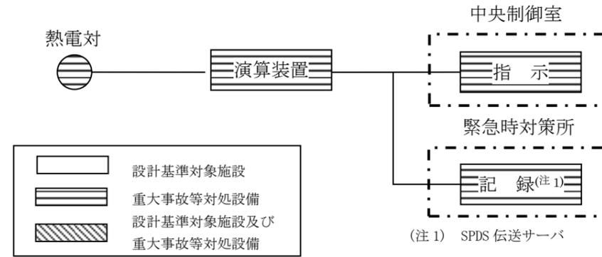
図4 スクラバ容器温度の概略構成図
