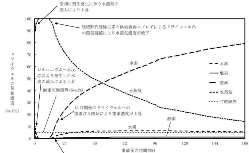
残留熱代替除去系の格納容器スプレイによるドライウエル内の蒸気凝縮により、サブプレッション・チェンバ内の非凝縮性ガスがドライウエルへ流入し、非凝縮性ガスの濃度が上昇
