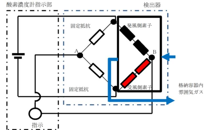
図6 酸素濃度検出回路の概要図
