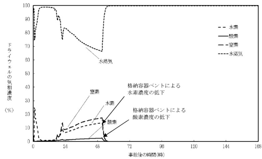
図 52-6-3 原子炉格納容器（ドライウエル）気相濃度
