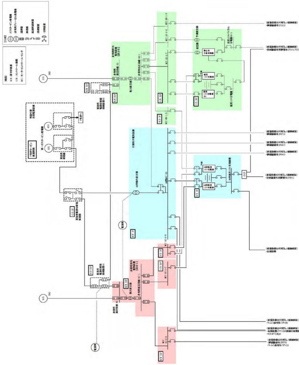
図50-2-1 格納容器圧力逃がし装置 単線結線図 (6号炉)
