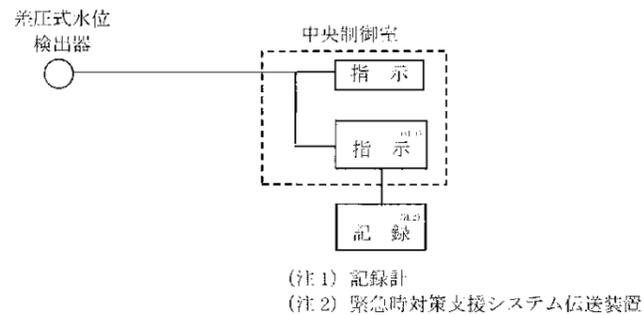
図50-3-3 フィルタ装置水位の概略構成図
