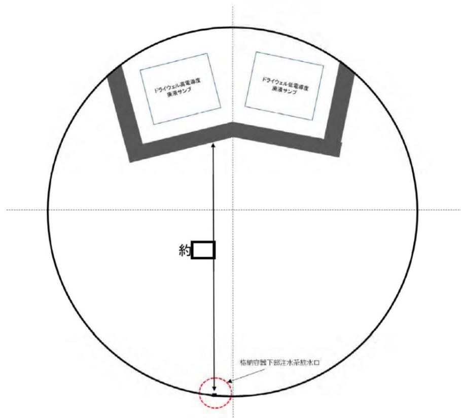
図2 コリウムシールドと原子炉格納容器下部注水設備放水口との設置位置概要図
