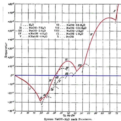
図6 水酸化ナトリウムの水系相平衡図<sup>[2]</sup>
