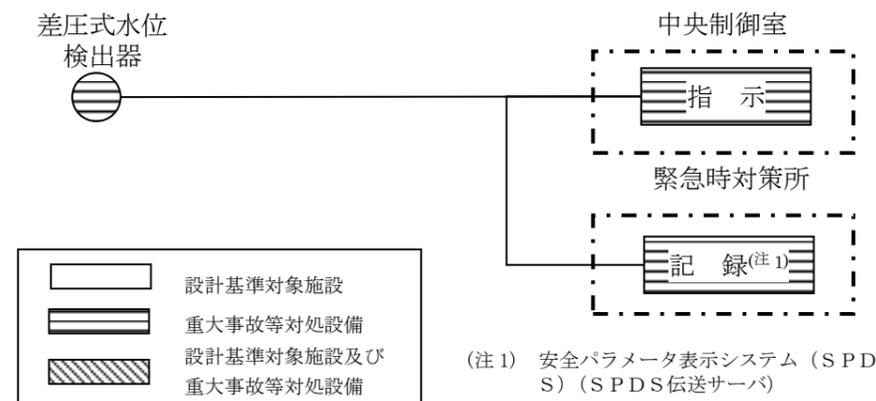
図2 スクラバ容器水位の概略構成図
