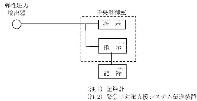
図50-3-4 フィルタ装置入口圧力の概略構成図
