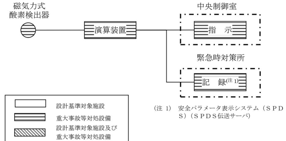
図3 格納容器酸素濃度 (SA) の概略構成図
