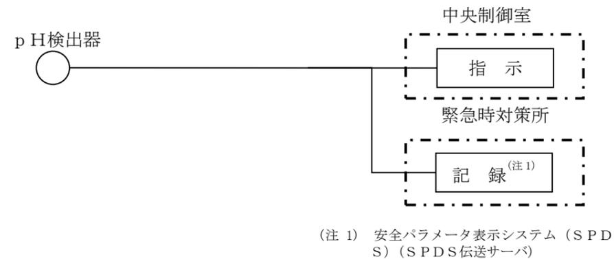
図10 スクラバ水pHの概略構成図
