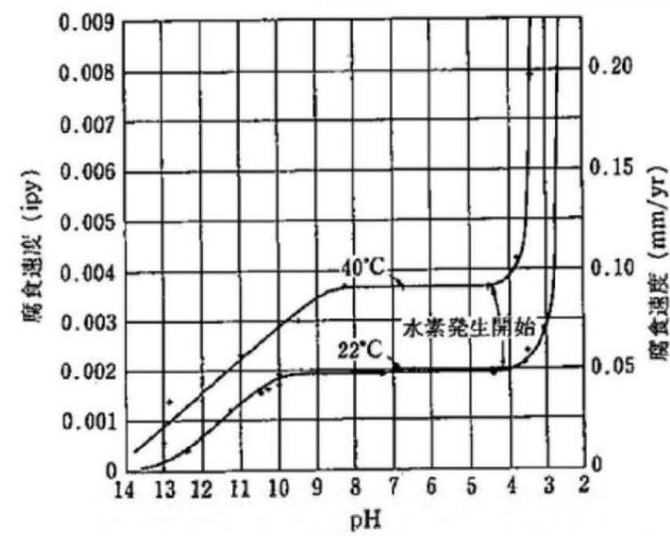
図50-11-3 炭素鋼の腐食に及ぼすpHの影響
