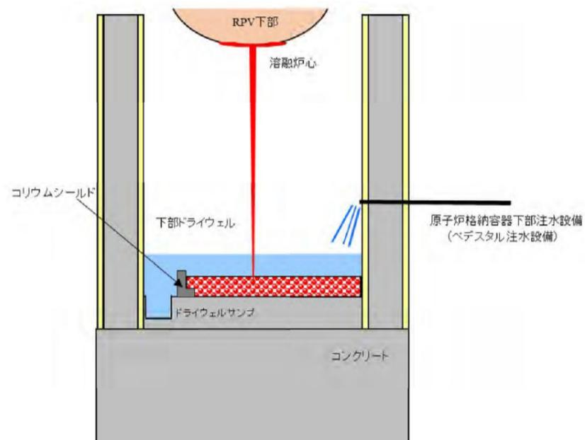
図1 コリウムシールド概要図 (7号炉を例示)
