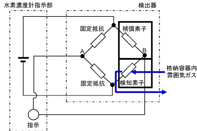
図52-7-2 水素濃度計検出回路の概要図
