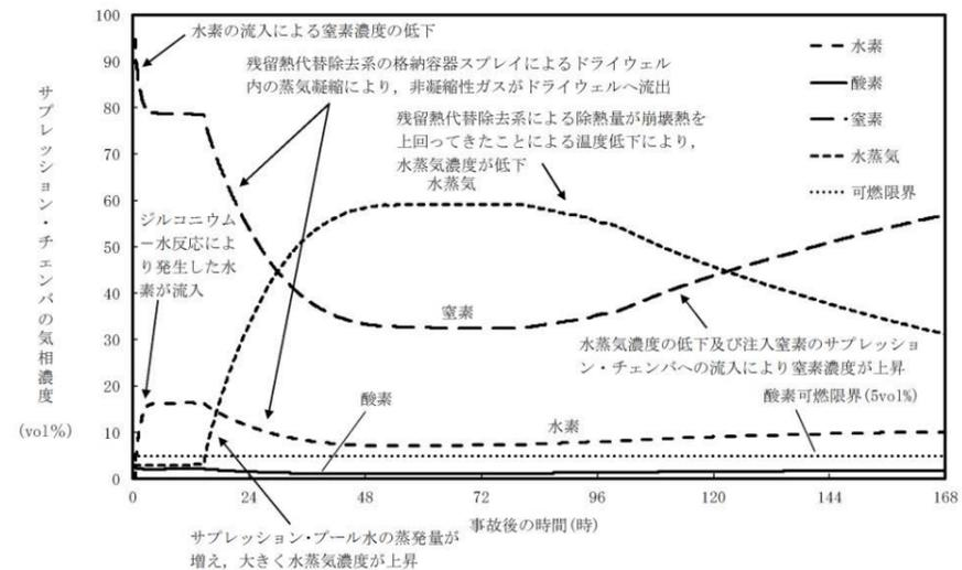
図2 サプレッション・チェンバ気相濃度の推移(ウェット条件)
