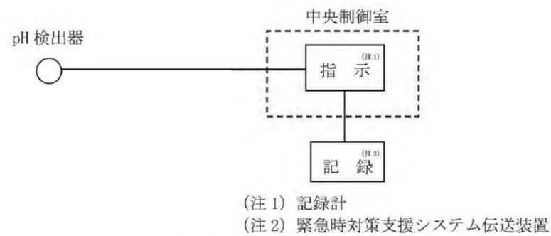
図50-3-12 フィルタ装置スクラバ水pHの概略構成図
