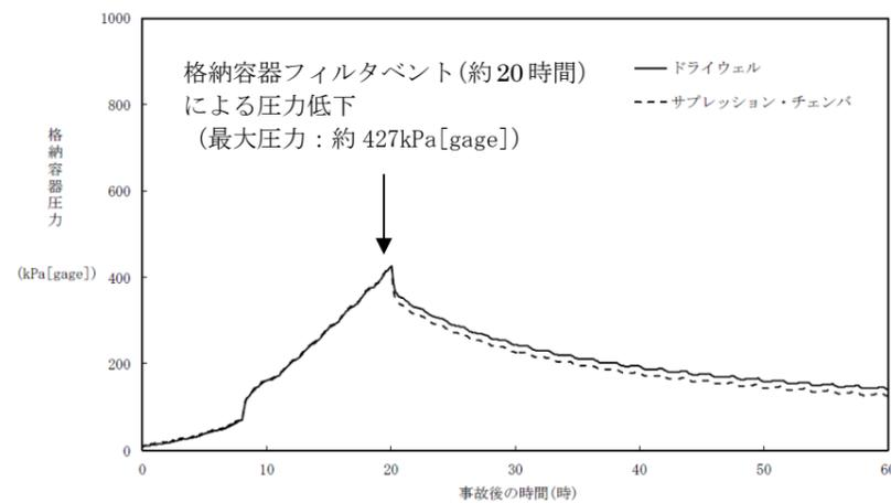
図 3 原子炉格納容器圧力推移 (長期 TB)
