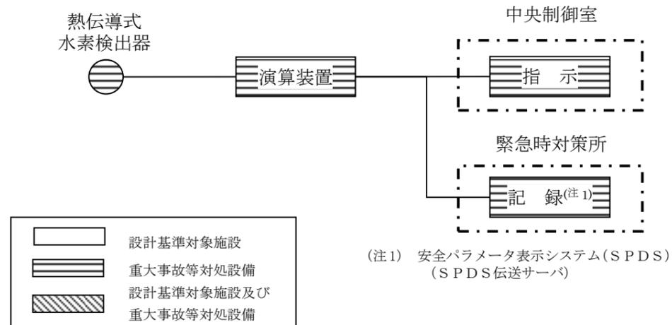
図 1 格納容器水素濃度 (SA) の概略構成図
