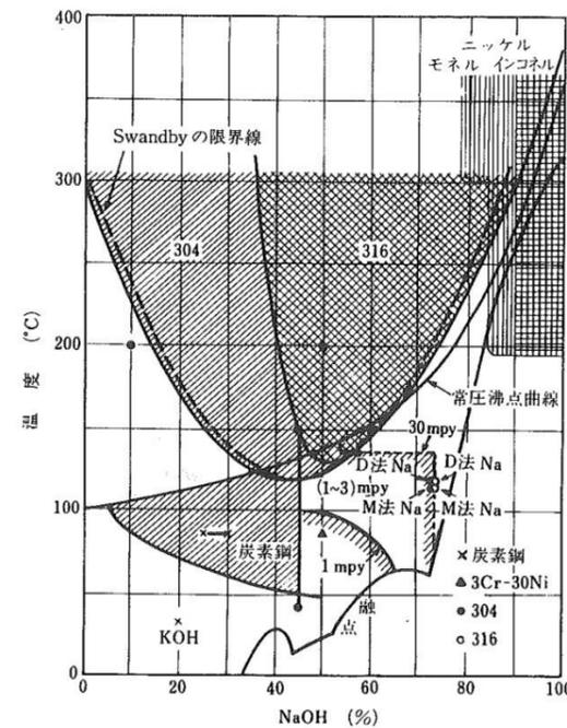
図4 アルカリ腐食割れに及ぼす温度、濃度の影響<sup>[1]</sup>
