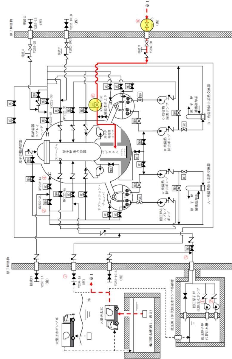
図3 ペデスタル代替注水系（可搬型）B系を使用したペデスタル内への注水の系統概要図
