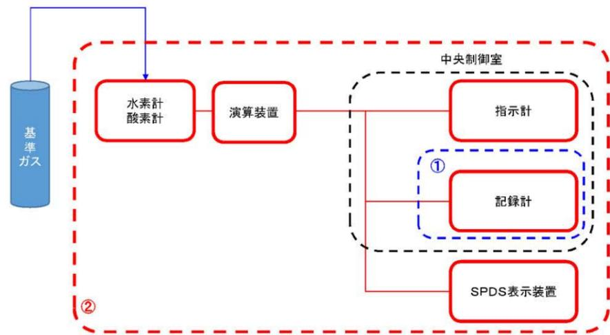
①記録計に模擬入力を実施し計器の校正を実施(点検)
