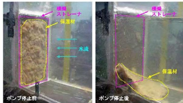
図50-11-7 ポンプ停止により模擬ストレーナから試験体が剥がれ落ちた試験
