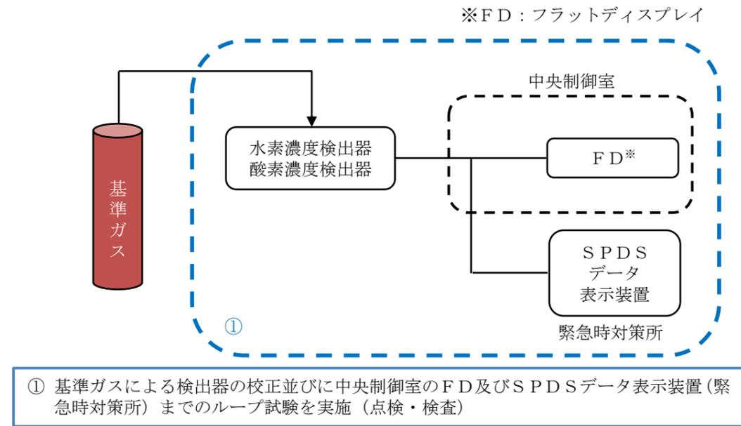
図2 計装設備の試験及び検査①
