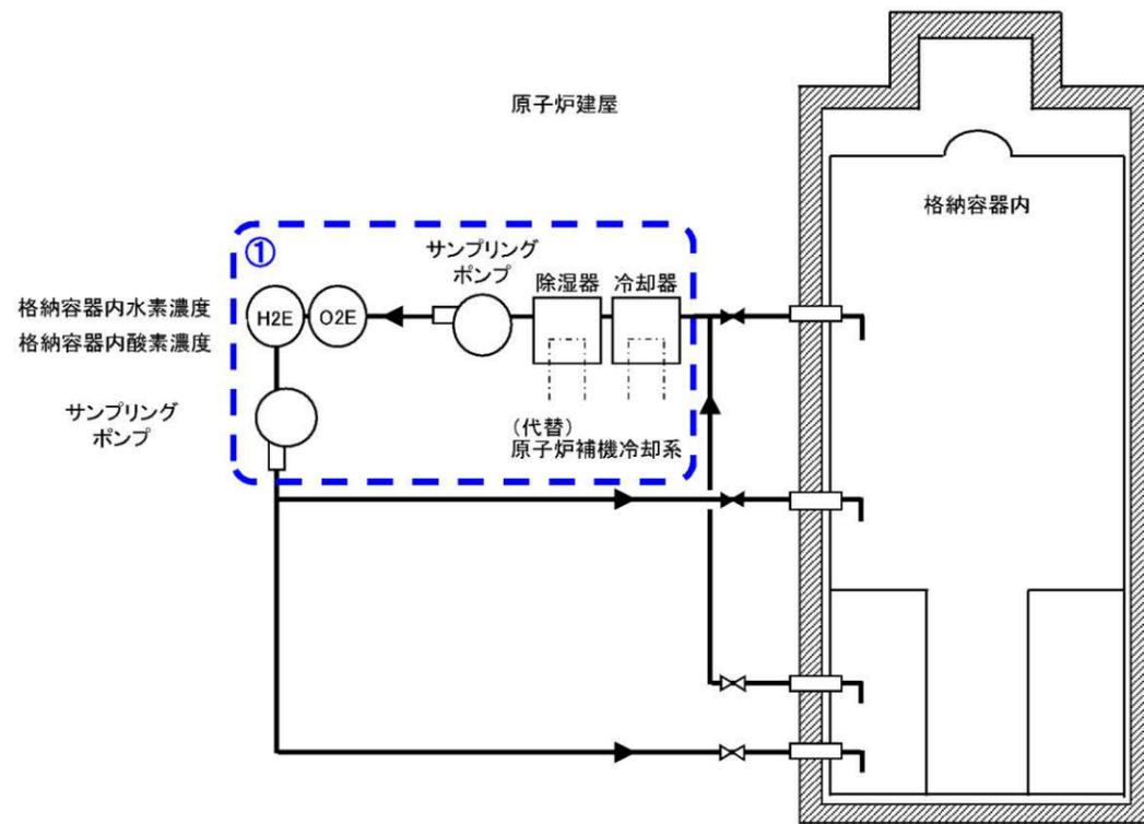
①サンプリング装置の運転性能、漏えいの確認を実施(点検・検査)
