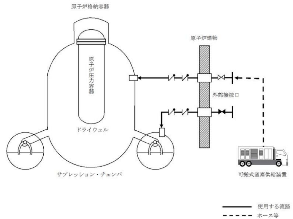
図1 窒素ガス代替注入系 系統概要図
