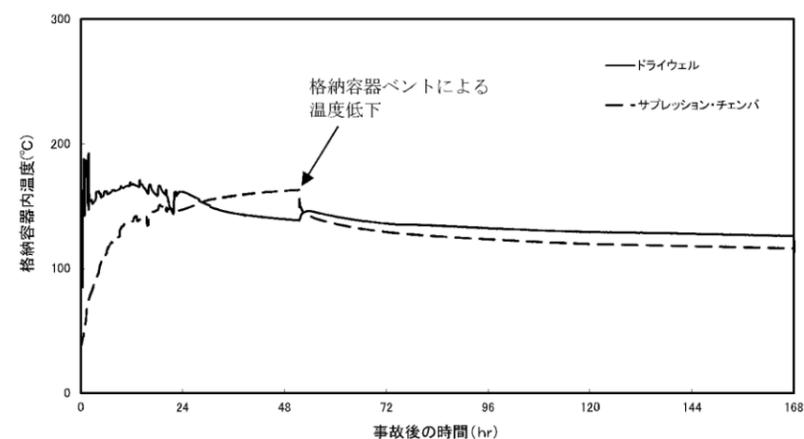
図 52-6-2 原子炉格納容器温度推移
