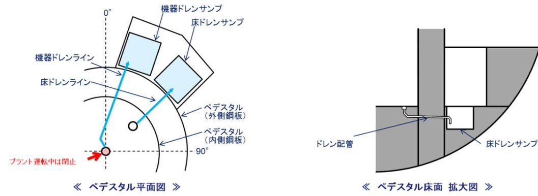
図1 ドレンサンプ概要図
