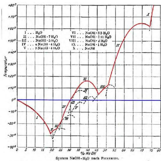
図50-11-4 水酸化ナトリウムの水系相平衡図
