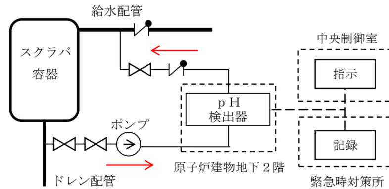
図9 スクラバ水pHシステム概要図
