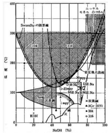
図50-11-2 アルカリ腐食割れに及ぼす温度、濃度の影響
