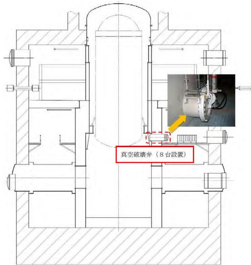
図 52-3-13 6/7 号炉 真空破壊弁 設置位置図
