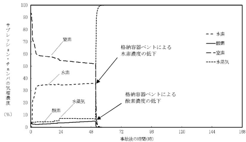
図 52-6-4 原子炉格納容器（サブプレッション・チェンバ）気相濃度
