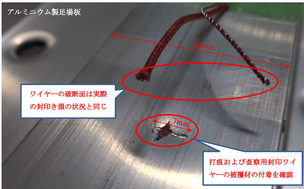
写真-2 き損再現試験
